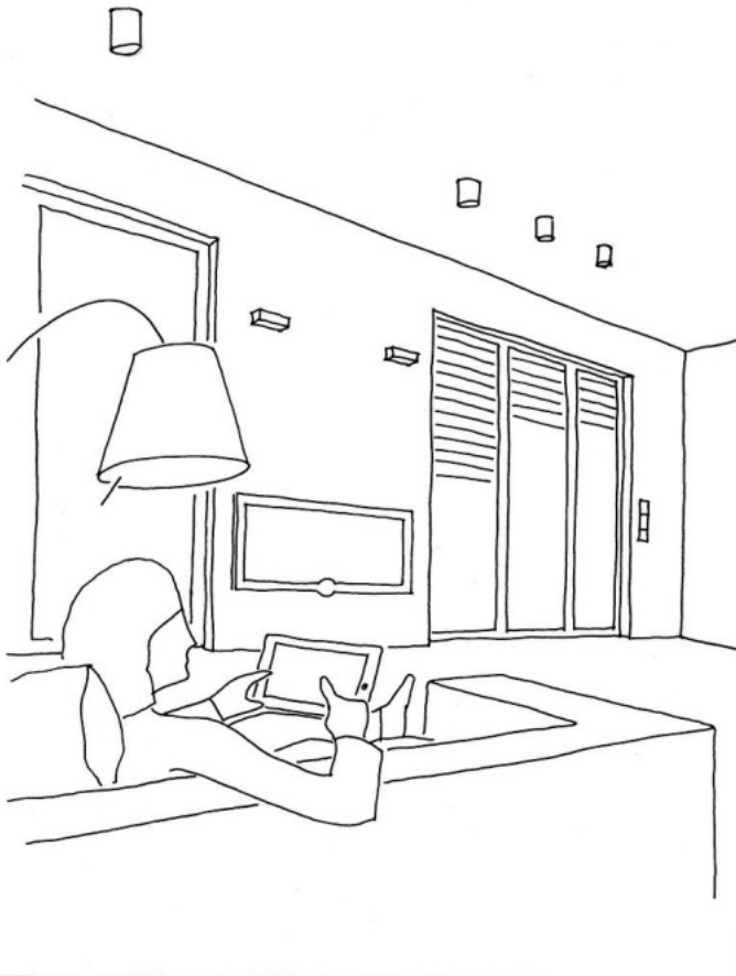
Haustechnik, etwa das Öffnen und Schließen von Rollläden, erleichtert den Alltag - elektrische Rollläden aber können den Fluchtweg versperren.
